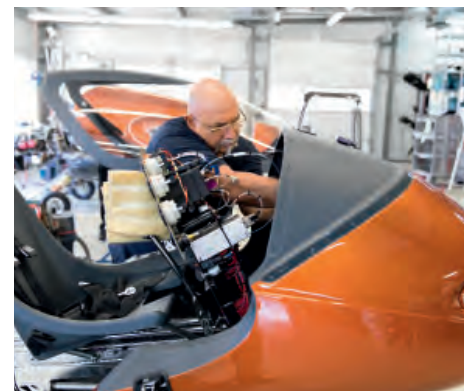
Окончательный монтаж кабины пилота: подключение бортового радиоэлектронного оборудования
