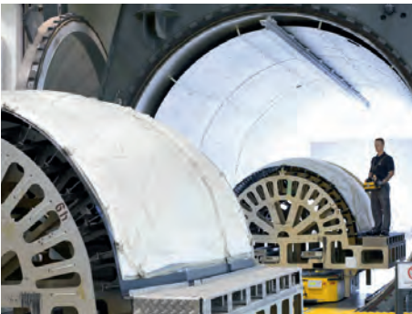
В автоклаве обшивка силовой установки проходит окончательную обработку
