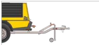
Нерегулируемое дышло без инерционного тормоза со стояночным тормозом наката
