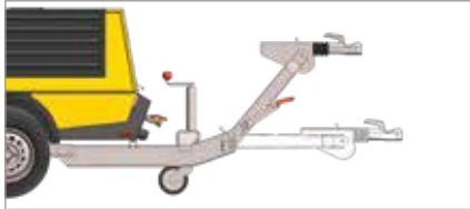
регулируемое по высоте дышло со стояночным и инерционным тормозом наката
