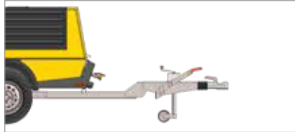
Нерегулируемое дышло с инерционным тормозом наката и стояночным тормозом
