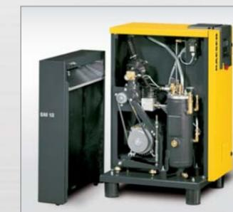
Проведение работ по техобслуживанию возможно с одной стороны. После снятия левого кожуха корпуса все узлы, подлежащие обслуживанию, легкодоступны. Контроль уровня масла и натяжения ремня может осуществляться через глазок, не снимая обшивки корпуса.
