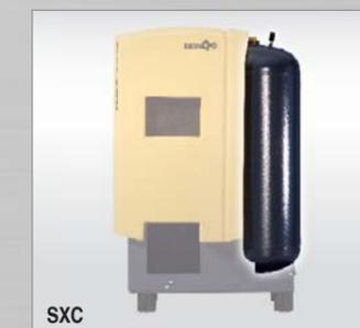
Ресивер с внутренним покрытием SXC-установок имеет три функции: охлаждение, хранение сжатого воздуха и предварительное отделение конденсата. Электронное управление контролирует отвод конденсата, не допуская потери сжатого воздуха.
