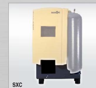
Холодоосушитель расположен под винтовым компрессором и полностью термически изолирован. «Сердцем» холодоосушителя является пластинчатые теплообменники из нержавеющей стали во встроенном сепараторе.
