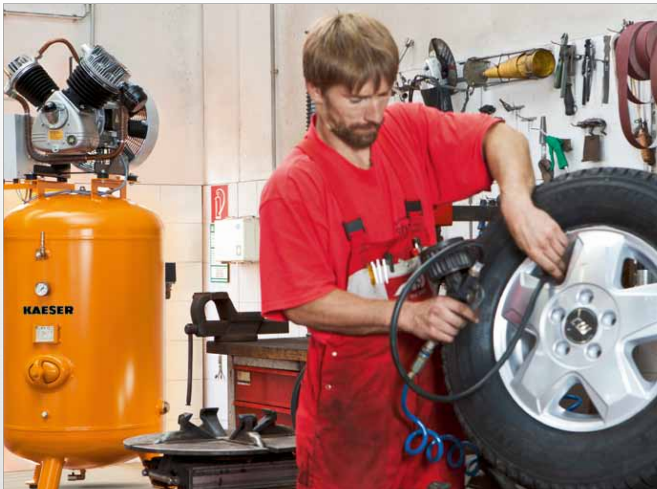
Поршневой компрессор EUROCOMP в автомастерской
