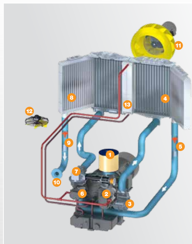
Рис.: Серийное исполнение DSG-2 (воздушное охлаждение)
